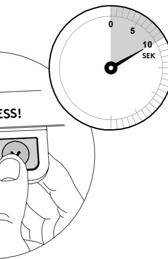
Fahren Sie die Tischplatte mit der Taste "Pfeil nach unten" zum tiefsten Punkt! Die Taste loslassen. Die Taste noch einmal herunterdrücken und sie ca. 10 Sekunden halten bis Sie eine kleine Bewegung der Tischplatte bemerken.
